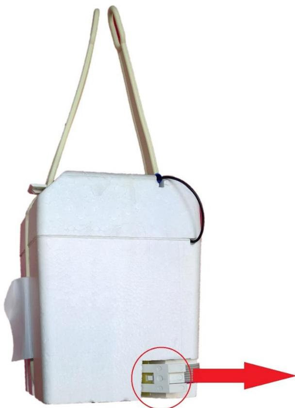
Блок датчиков потянуть на себя для извлечения из корпуса радиозонда.
